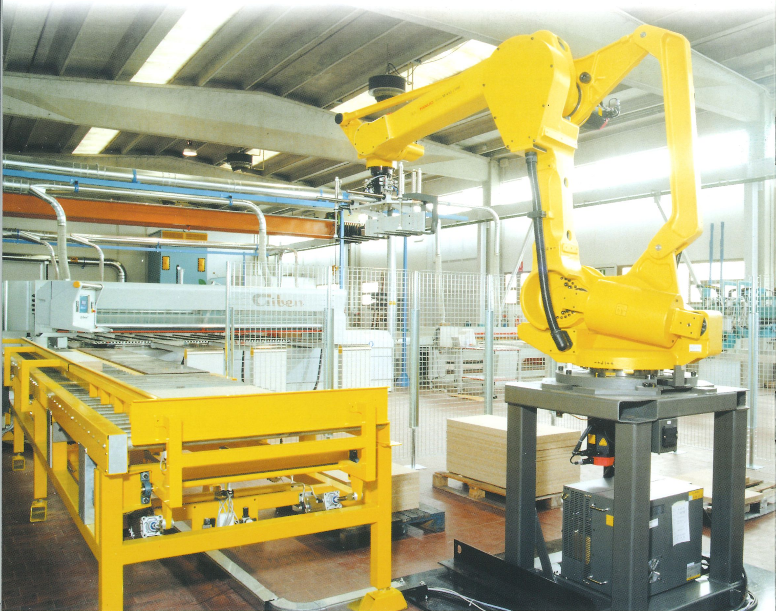
Die Abbildung zeigt eine Lösung für die Teilevereinzlung und Abstapelung der geschnittenen Fixmasse.
